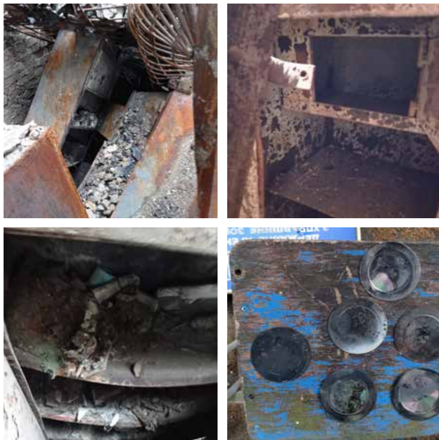
Рис. 6 – Пошкоджені джерела іонізуючого випромінювання та місця зберігання
