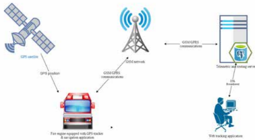
Рис. 11. Компоненти системи відстеження переміщення пожежних автомобілів.
